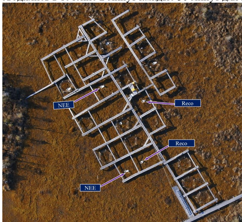
Рисунок 2 – Схема расположения участков с контрольными камерами в мочажинном комплексе верхового болота Мухрино (NEE – прозрачные камеры; R_{\text{eco}} – непрозрачные камеры) (составлено автором)
